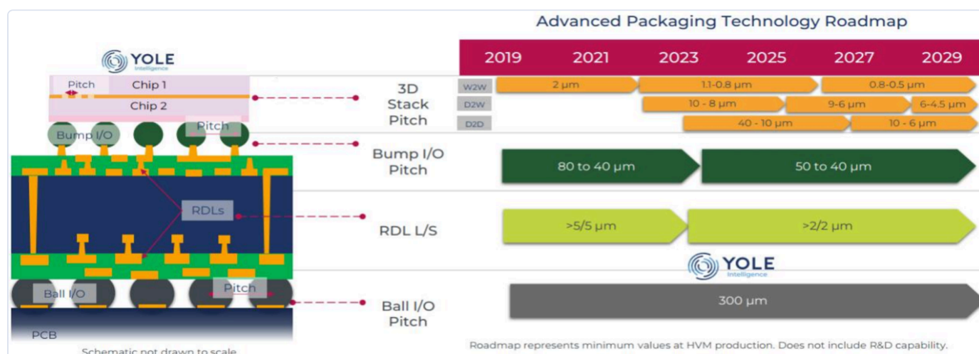
圖3：先進封裝技術路線圖 ( YOLE · 2019-2029 )。RDL L/S 從 >5/5\mu\text{m} 降至 >2/2\mu\text{m} ；3D Stack Pitch ( W2W/D2W/D2D ) 從 >5\mu\text{m} 降至 <1\mu\text{m} ；Bump I/O Pitch 從 80 \mu\text{m} 降至 40 \mu\text{m} 。( 來源：福邦證券 · 2025-06 )
