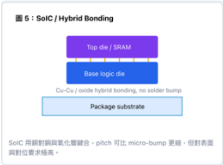
圖6：SoIC / Hybrid Bonding 截面。Top die ( SRAM/記憶體 ) 以 Cu-Cu + SiCN 直接鍵合至 Base logic die，無焊料，互連 pitch 從 \mu bump 的 40 \mu m 縮至 <10 \mu m，頻寬密度提升 10-100 \times 。（來源：晶圓到先進封裝全流程，2026-05）
